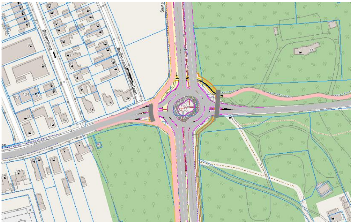
Afbeelding 6: variant 3, twee keer twee stroken (fietsers uit de voorrang op de noordelijke oversteek), afgekapte rechtsafer vanaf de Bennekomseweg na de aansluiting met de Zandlaan.
